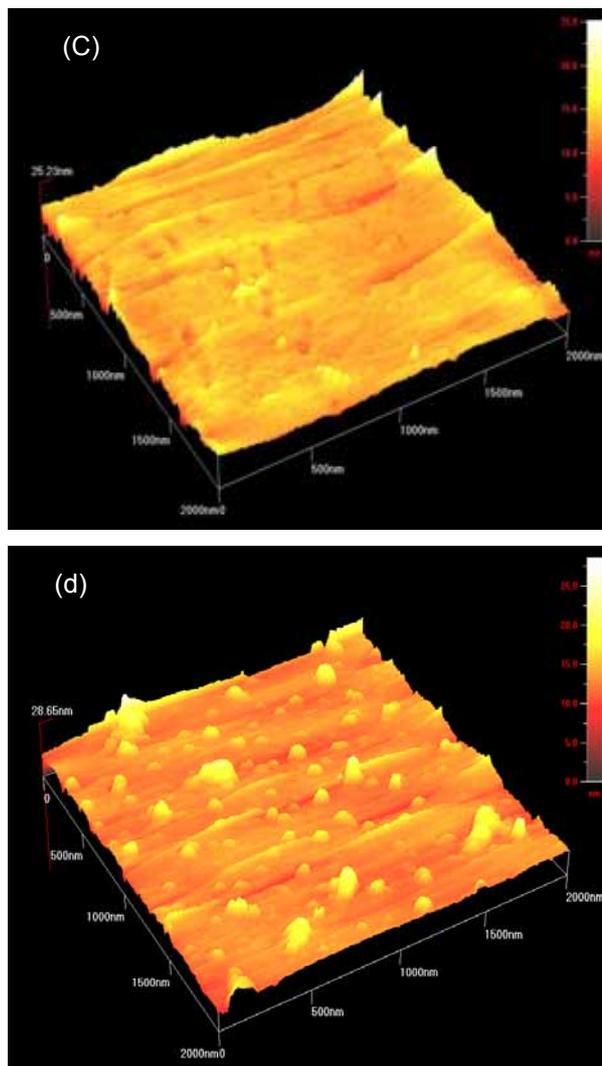
Figure 3. AFM images (c) As grown (d) film annealed at 200°C
