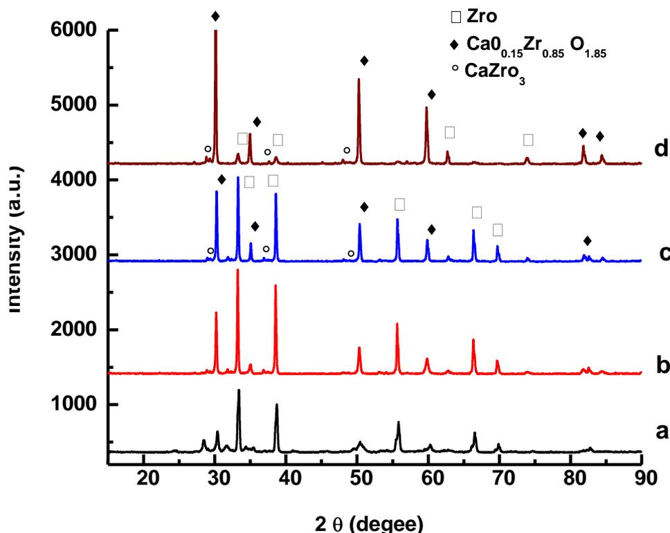
Figure 1(a-d). X-ray diffraction pattern (a) 4CSZ, (b) 8CSZ, (c) 12CSZ and (d) 16CSZ.
